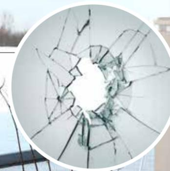
**GEWÖHNLICHES FENSTERGLAS** zersplittert bei Glasbruch, wodurch ein hohes Verletzungsrisiko besteht.
