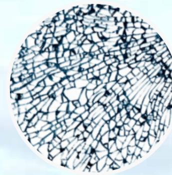
**EINSCHEBEN-SICHERHEITSGLAS** zerbricht im Bruchfall in kleine stumpfe Krümel. Die Gefahr von Schnitt- und Stichverletzungen ist dadurch deutlich reduziert.
