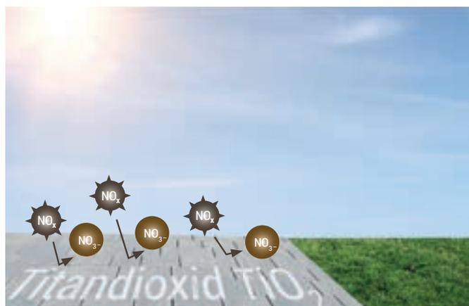
Mithilfe von Sonnenlicht wandelt Titandioxid (TiO<sub>2</sub>) Stickoxide (NO<sub>x</sub>) in Nitrat (NO<sub>3</sub><sup>-</sup>) um.
